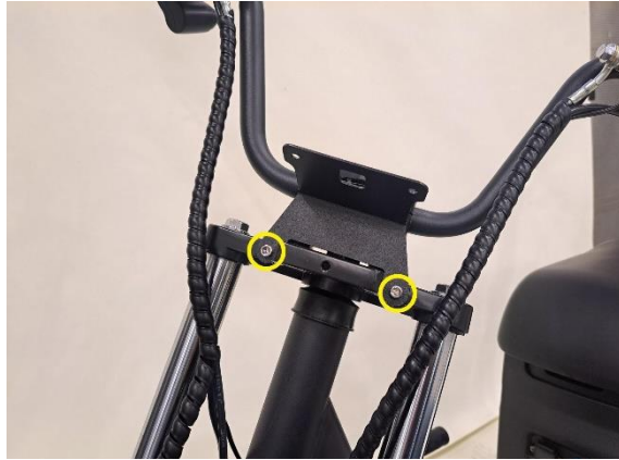
Irrota mittariston kiinnikkeen kiinnityspultit (kuusiokoloavain 5 mm).
