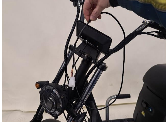
Pujottele mittariston johto irralleen.
